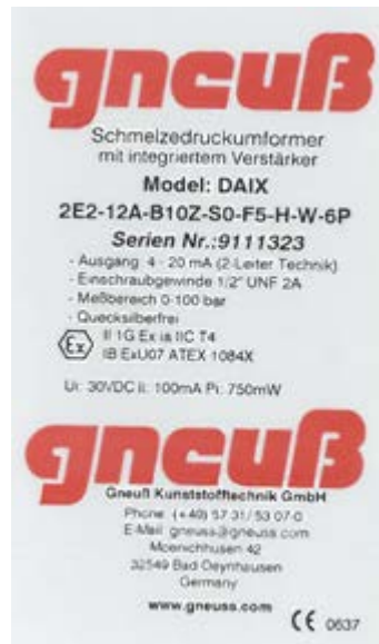
Abb. 1 Typenschild für Gerät mit Ex-Zulassung
